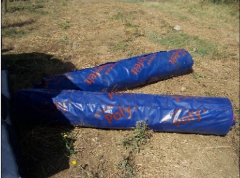
Abbildung 4 – Vliesstoffbahnen (TNT), die zur Auskleidung der Drainagesäcke IDROSAC 500 auf dem Weingut in Montalcino verwendet wurden
