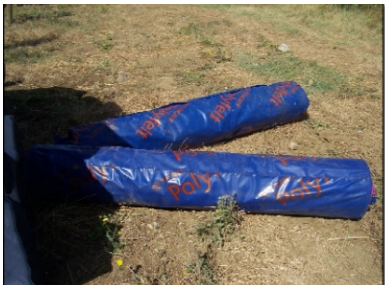
Figura 4 - Piezas de geotextil no tejido (TNT) utilizadas para recubrir las bolsas drenantes IDROSAC 500 en la finca de Montalcino
