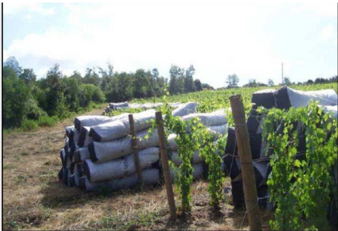
Figura 2 - Sacos drenantes flexibles de tejido no tejido mod. IDROSAC 500 utilizados
